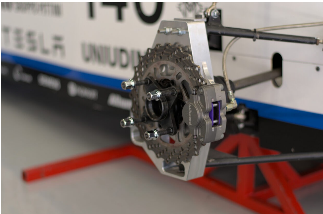
Figura 5 - Panoramica su disco e pinna impianto frenante monoposto UNIUD
